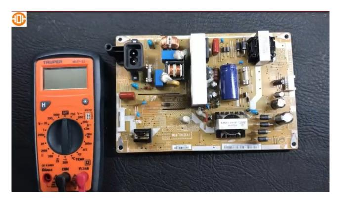
Entonces para comenzar con este método lo primero que se debe hacer es en una placa como ésta que es una placa de un televisor pero es una fuente conmutada si se observa hay capacitores acá que indican que pueden llegar a cargarse con un voltaje bastante alto.
