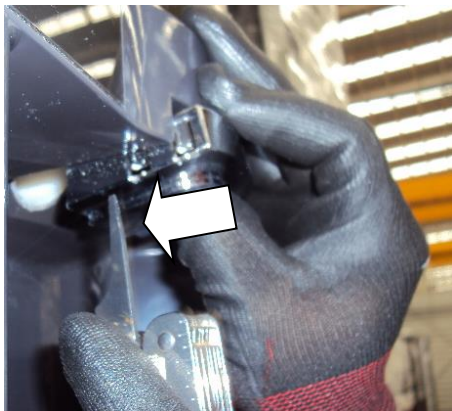
14.- Para liberar el actuador liberar 4 seguros con desarmador punta plana tipo clemero y el resorte va en la posición indicada y se retira jalándolo.
