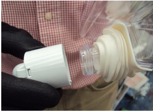
7.- Válvula y grommet liberados.
