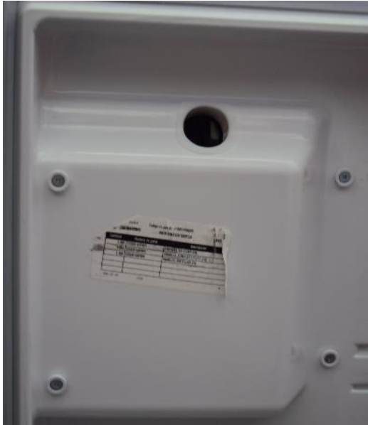
13.- El panel va sobre 4 contras y 4 tornillos cabeza Phillips.
