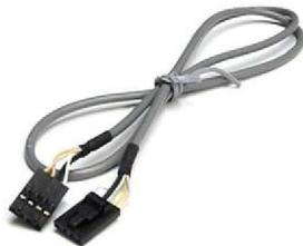
El cable de sonido que transmite pulsos desde el CD-ROM a la entrada de sonido interno en la motherboard es necesario en equipos que trabajan con placas AT o ATX, para que los CDS de música puedan oírse.
