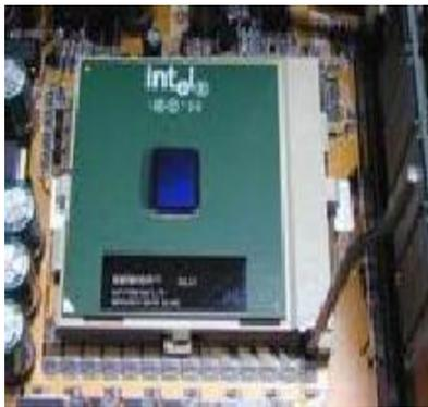
Localiza el socket del procesador en la tarjeta madre y ubica la muesca que indica como debe ser colocado correctamente el procesador en esta, levanta la palanca o seguro que tiene este socket, posteriormente coloca el procesador de acuerdo a la muesca que lleva impresa el procesador en la parte superior en una de las esquinas, y baja la palanca para asegurar el procesador. Para terminar asegura el disipador del procesador a los ganchos.
