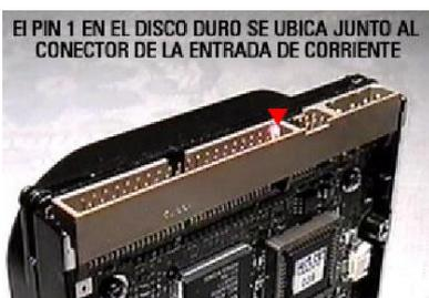
La ubicación del PIN 1 en un disco duro es una consideración importante para conectar discos duros. En el costado del pin debe alinearse la línea marcada con color (rojo o azul) del cable de datos que comunica al disco con la motherboard y posteriormente conectar el disco al cable de alimentación.
