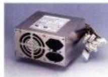
También destacar que comparadas tecnológicamente con las fuentes ATX, las AT son un tanto rudimentarias electrónicamente hablando. En ATX, es un poco distinto, ya que se moderniza el circuito de la fuente, y siempre está activa, aunque el PC no esté funcionando, la fuente siempre está alimentada con una tensión pequeña para mantenerla en espera.
