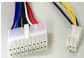
Los conectores de una fuente de energía de tipo ATX, para alimentar de corriente a motherboards modernas ATX. El conector grande reemplaza a los dos conectores (P8 y P9) que se utilizaban con las fuentes AT. El conector pequeño se utiliza en ALGUNAS motherboards cuando el fabricante así lo ha diseñado.
