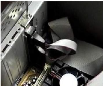
Las tarjetas de red, MODEM o video deben ser colocadas en sus ranuras o spot respectivos, deben estar bien colocados y no moverse fácilmente para que pueda ser reconocido sin ningún problema por la tarjeta madre y el sistema operativo. Posteriormente asegurarse la tarjeta con un tornillo.
