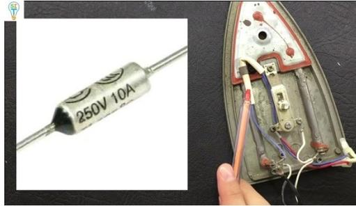
**Las fallas y posibles causas;** En el caso de que no caliente la plancha y la luz de Neón este apagada entonces lo que se tiene que revisar es el fusible térmico, el termostato y el cable.
