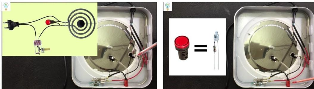
**Las fallas y posibles causas;** en el caso que la resistencia no encienda ósea que no haya calentamiento y la luz de LED piloto este apagada también; entonces lo que se debe revisar es el termostato y el cable desde la conexión hasta sus terminales.
