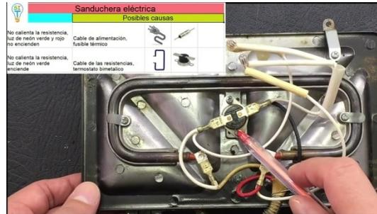
➤ **Como sería la medición de algunos componentes con el multímetro:** se debe comenzar colocando el multímetro en la escala de Ohmio ya que todos los elementos que se van a medir tienen un nivel de ohmio muy bajos o son circuitos abiertos. Posteriormente si unimos las dos puntas del multímetro nos va a dar una medida de 0,1.
