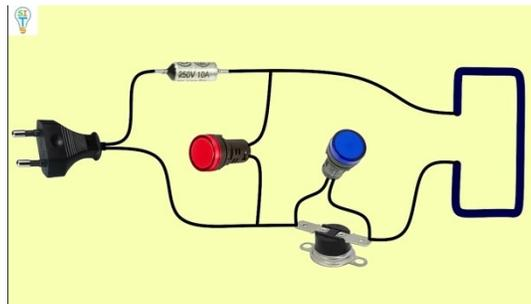
Al observar el reverso vemos un cable negro el cual se va a ir y conectarse al termostato y el cable que sale del termostato va a la resistencia donde se cierra el circuito.
