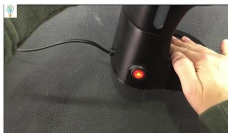
Podemos observar el circuito que tiene, donde nos indica que el interruptor principal tiene tres pines y sin embargo es un interruptor simple ya que él internamente tiene una lámpara de Neón.
