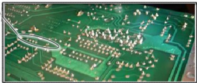
Los tres puntos de soldadura están agrietados. Puede no parecer mucho, pero este tipo de anomalía causa la pérdida momentánea de la conexión. la corrosión se acumulan en estas grietas. Para verificar si una ecu presenta este tipo de fallas necesariamente se debe de realizar una inspeccion visual.
